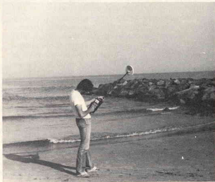
Fig. 6 - Regolazione dei controlli per l'esclusione dell'effetto "del terreno".
