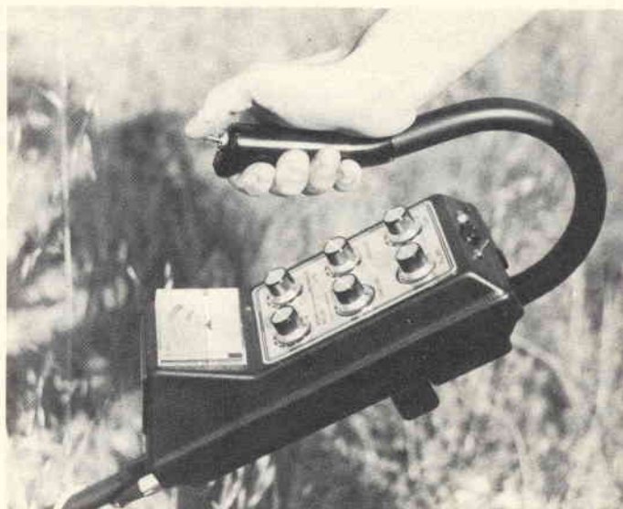
Fig. 1 - C-SCOPE VLF/TR 3000 ADC: azionamento del deviatore a leva, posto sulla manopola di sollevamento, che serve a stabilire la "qualità" del ritrovato.
